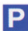
E5 Autorisation de stationner du côté de la voie où le signal est placé
