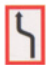
B2a Obligation de se diriger vers le côté du chenal se trouvant à bâbord
